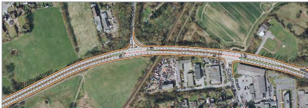
Abbildung 10-48: Planfall 3, Streckenführung, Querschnitt ausgebauter Wellseedamm (Abschnitt 3 und 4)
