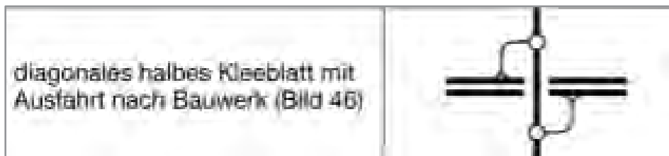
Abbildung 10-9: schematische Darstellung der Anschlussstelle Kronsburg nach RAA Bild 44
