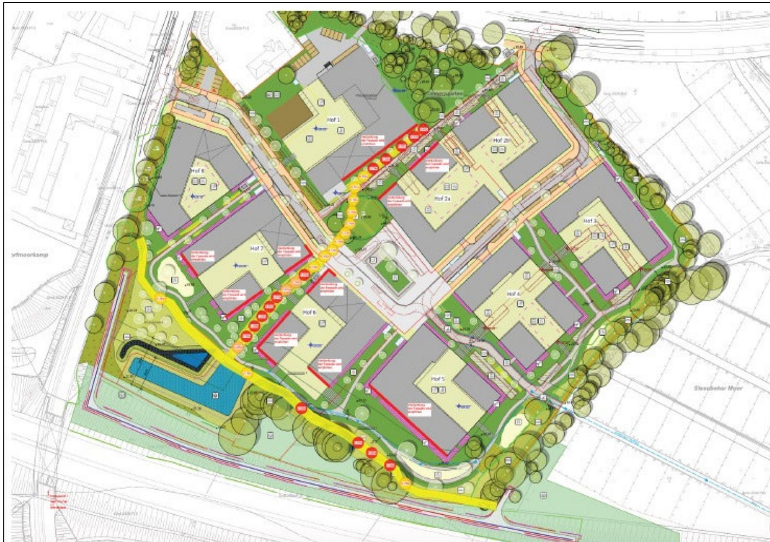
Abbildung 13: Übersicht der Untersuchungsergebnisse des Lichtgutachtens (aus [REDACTED] 2022). An den rot markierten Gebäudefassaden wird aufgrund der Ergebnisse voraussichtlich eine automatische Verdunkelung z.B. mit Textilscreens erforderlich.
